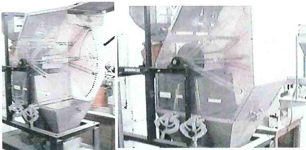
Figura 10: Fotos do separador eletrostático utilizado.
