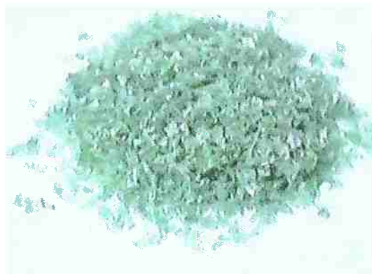
Figura 6: Flocos de PET verde moídos e peneirados.
